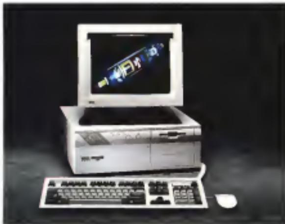
ingegneristiche o multimediali. Può montare un floppy disk drive da 3.5" o 5.25" ed un hard disk da 110, 200 o 300 Mbyte.
